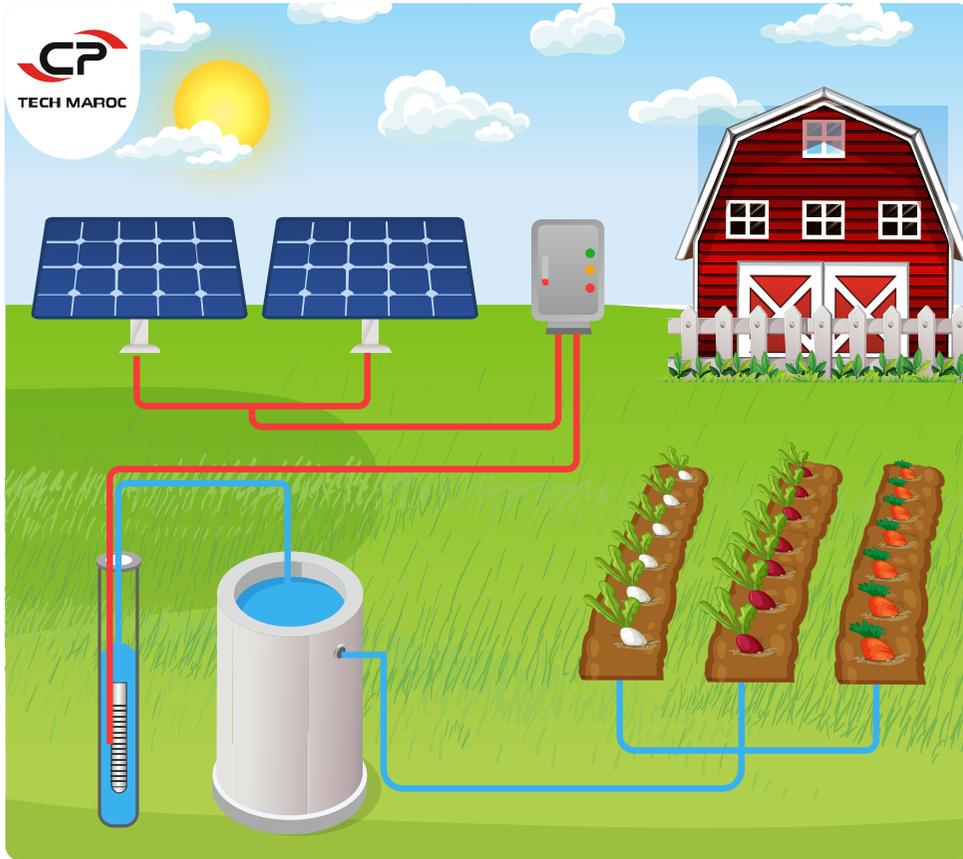
Le pompage solaire consiste à capter l'énergie solaire via des panneaux photovoltaïques pour produire de l'électricité qui alimente une pompe permettant d'assurer l'exhaure de l'eau.
